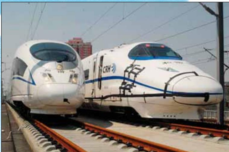
Hochgeschwindigkeitszug der CRH-Serie der Chinesischen Eisenbahnen für den Verkehr mit der Geschwindigkeit bis zu 350 km/h auf der Hochgeschwindigkeitslinie Peking - Tianjin (China)
